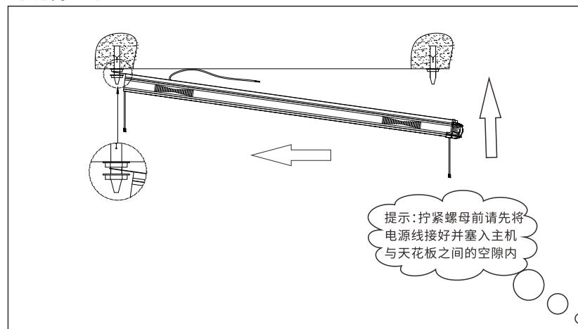
7、取出剪刀架，将剪刀架上滑轨左侧葫芦孔套在主机端部安装板左侧螺丝上，拧上右侧螺丝，最后拧紧两个螺丝。
